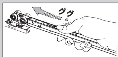
□ ①上レールを固定し、④スライド式受け金具の取付け後、図のようにソフトクローズ機能の確認を行ってください。
