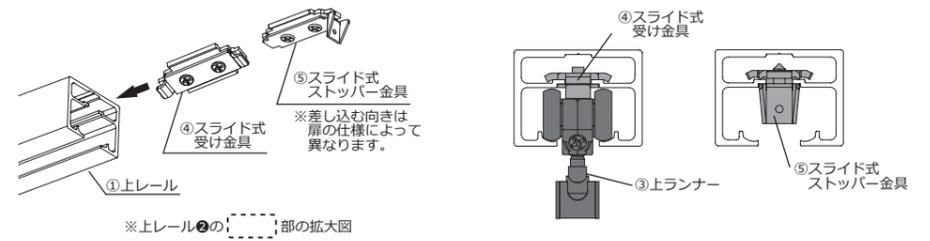
スライド式受け金具の間に隙間を作らずにそのまま差し込んでしまうと、ソフトクローズ機能が作動しない原因となります。必ず、上のプレートと下のプレートに隙間を作り、レール中段へ差し込むように取付けてください。
