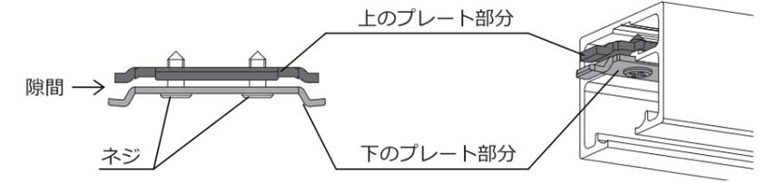
扉調整用ネジが扉外側へ向くように入れてください。扉調整用のネジが内側に向いてしまうと上下調整が出来なくなります。
