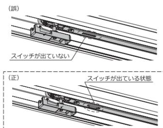
①開方向、閉方向に強く押し付けてください。
