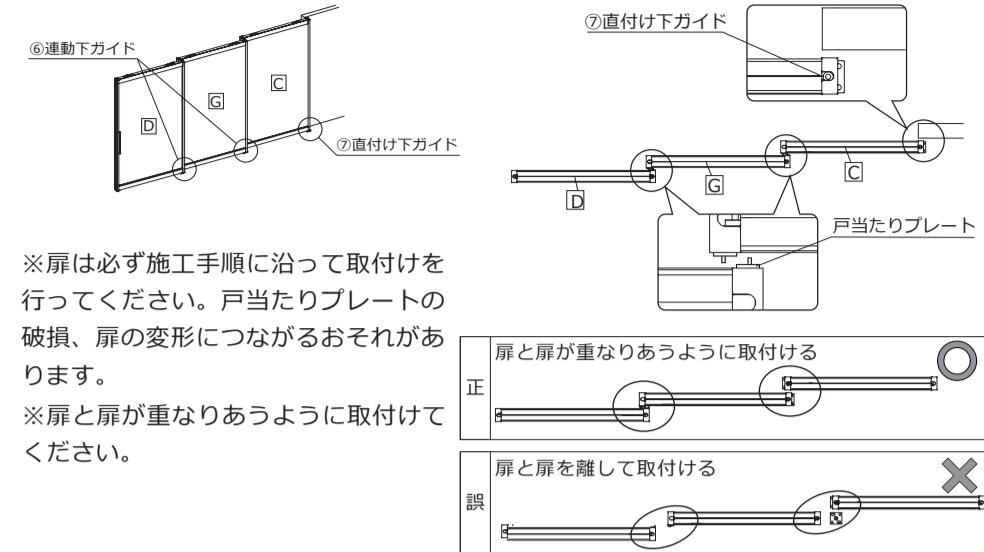
※扉は必ず施工手順に沿って取付けを行ってください。戸当たりプレートの破損、扉の変形につながるおそれがあります。
