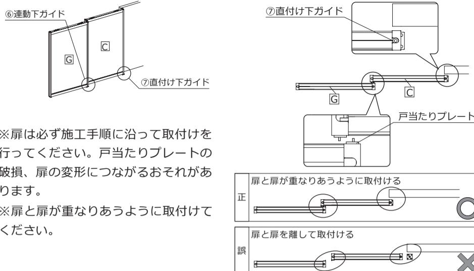
※扉は必ず施工手順に沿って取付けを行ってください。戸当たりプレートの破損、扉の変形につながるおそれがあります。
