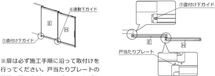
※扉は必ず施工手順に沿って取付けを行ってください。戸当たりプレートの破損、扉の変形につながるおそれがあります。
