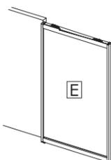
⚠ 扉Eの吊り込み後、必ず床とのクリアランスを確認してください。
