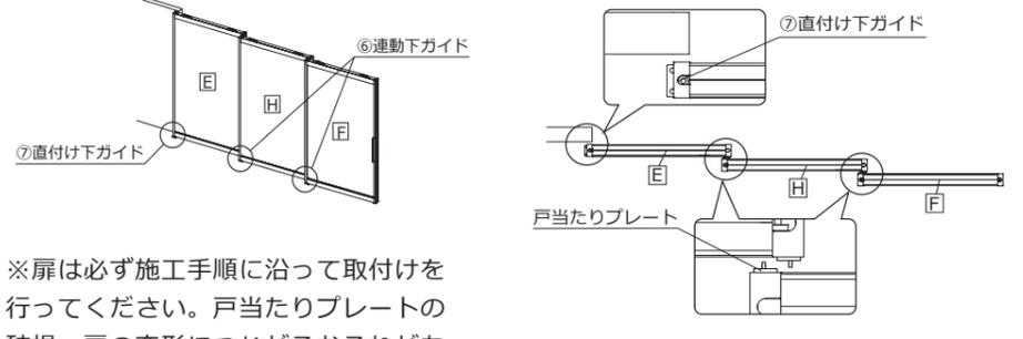
※扉は必ず施工手順に沿って取付けを行ってください。戸当たりプレートの破損、扉の変形につながるおそれがあります。
