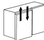
③のネジをゆるめて、扉の上下調整をしてください。調整後ネジを締めつけてください。
