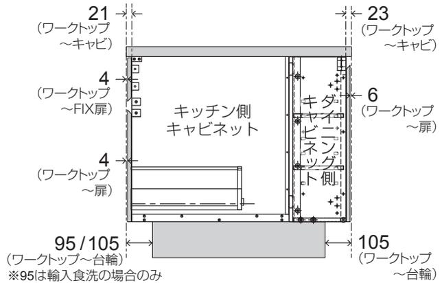
バックパネル型 詳細納まり図(D670)
