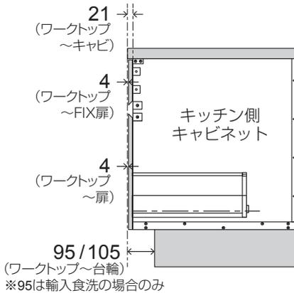
ダイニング側収納型 詳細納まり図(D900)
