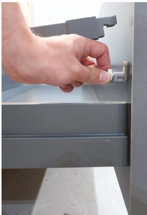
サイドレールを元の位置に戻した後、フロントカバーを元の位置に戻します
