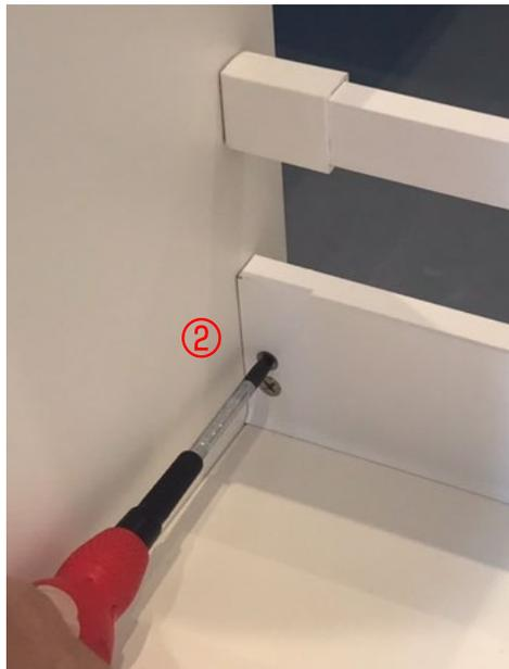
③の高さ調節ネジを回して高さを調整し、②の固定ネジを締め付けます。
